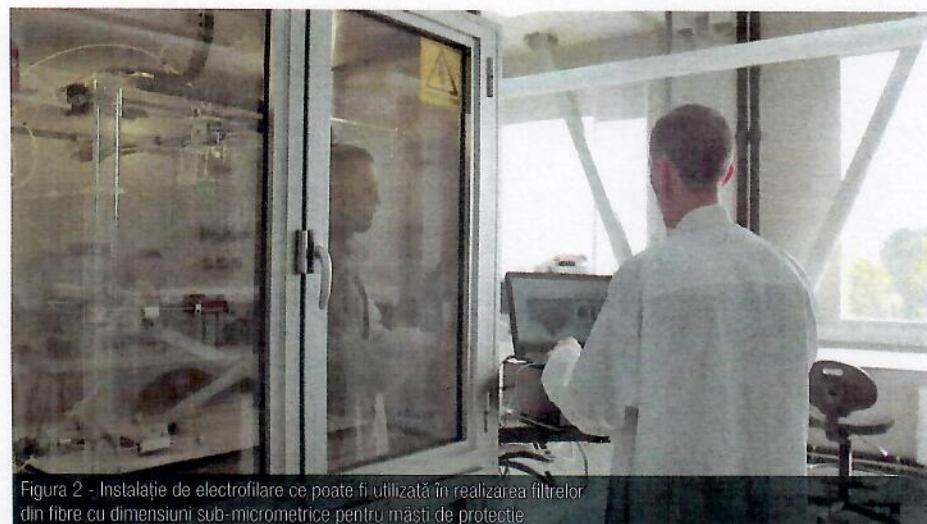
Figura 2 - Instalație de electrofilare ce poate fi utilizată în realizarea filtrelor din fibre cu dimensiuni sub-micrometrice pentru măști de protecție
