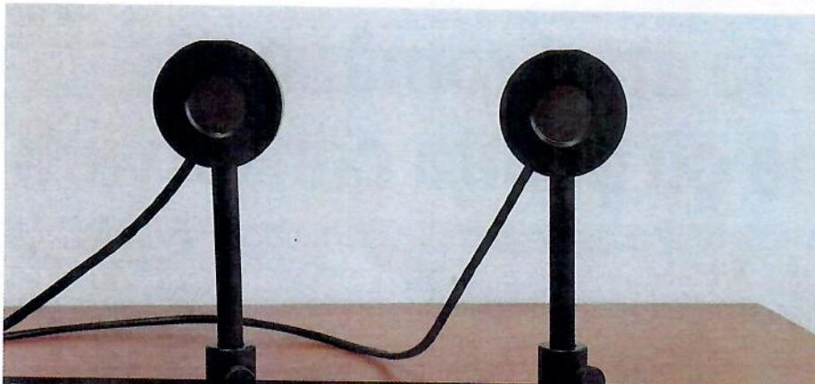
Figura 3 - Detectori piroelectrici pentru radiație infraroșie, utilizati pentru măsurarea energiei fasciolelor laser. Astfel de elemente de detecție pot fi utilizate și pentru măsurarea temperaturii de la distanță, în conjuncție cu un sistem optic de formare a imaginii subiectului pe suprafața elementului de detecție. INCDFM produce astfel de elemente de detecție, și are expertiza necesară, alături de producerea de pirometre portabile, cât și fixe.
