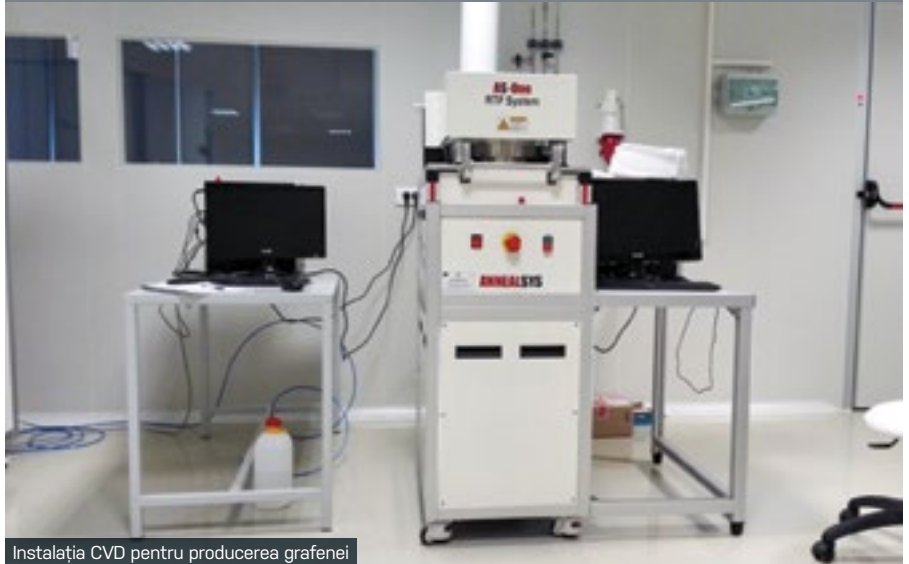
Instalația CVD pentru producerea grafenei
