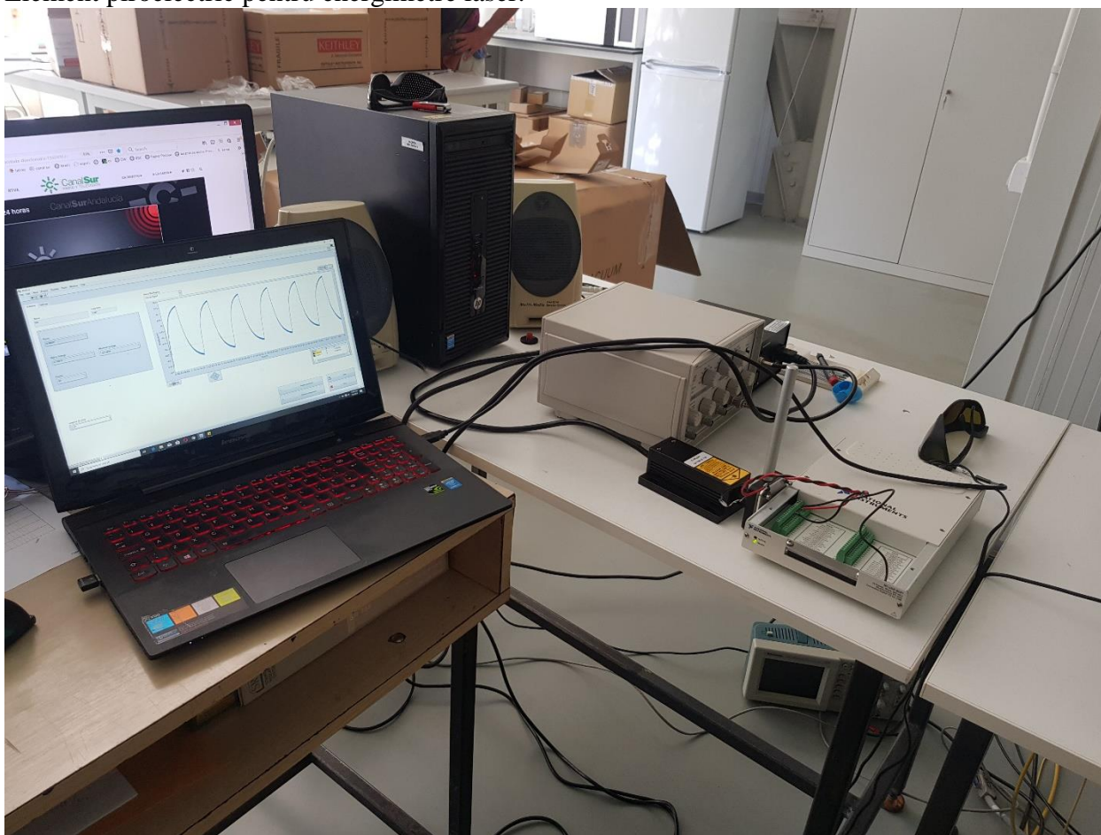
Semnal generat de elementul piroelectric si procesat electronic pentru afisare pe calculator.
