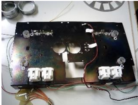
Montare suportii lampi
