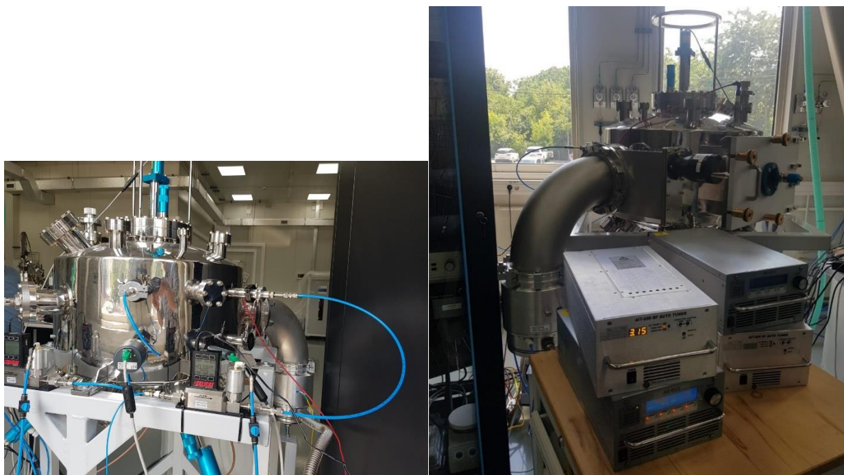
Partea de pulverizare in radiofrecventa cu magnetron (incinta de depunere si sursele pentru magnetroane).
